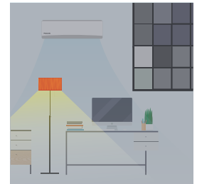
Detekcja nasłonecznienia System dostosowuje moc chłodzenia do zmian natężenia światła słonecznego.
